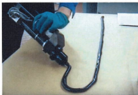
Ruční aplikace 1K polyuretanu s urychlovačem vytvrzení.
