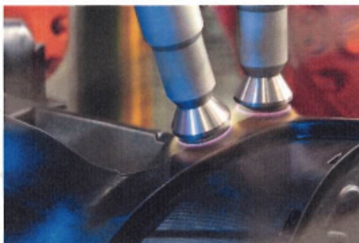
Úprava povrchu plazmou (Zdroj Plasmatreat)
